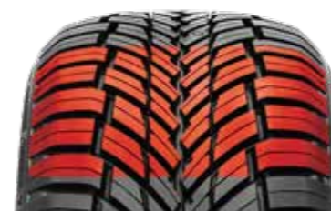
ODVODŇOVACÍ DRÁŽKY AQUEDUCT
