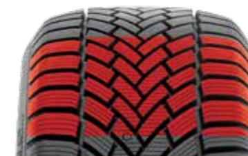
ODVODŇOVACÍ DRÁŽKY AQUEDUCT
